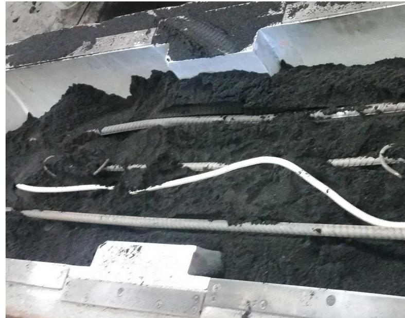
Se ubican venteos en el corazón creando un camino de salida para los gases sin atravesar la pieza.
