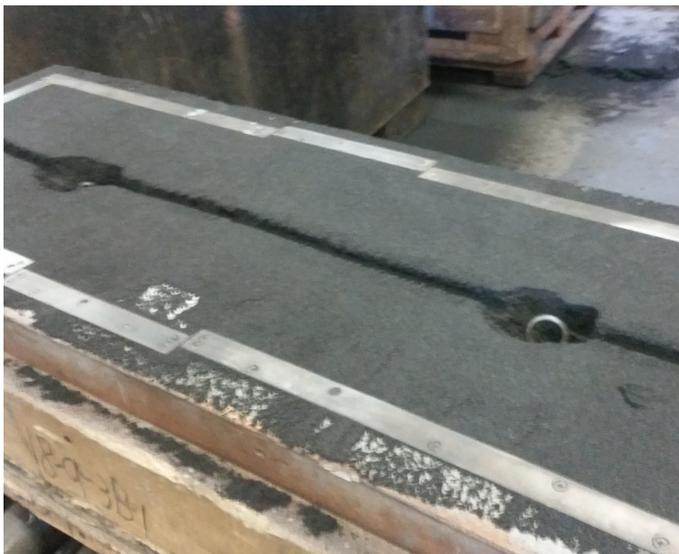
Luego de llenado el corazón, se muestra el extremo del venteo donde escapan los gases.
